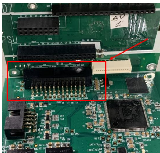
Рисунок 4. Подключение электронных сборок TX1N2 и MCU
